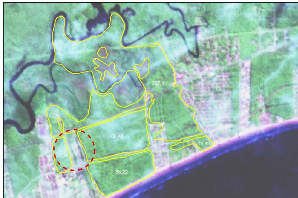
FIGURA 14: Região de Bertioga-SP: Imagens LANDSAT-7, sensor TM, RGB345+PAN, com resolução espacial de 15 metros, cena 219-076 de 17/6/2000 (detectada uma redução de área de um dos polígonos de 16,56 ha).
